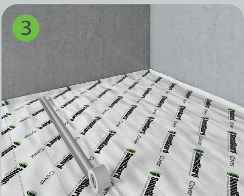
Стыки материала проклеиваются клейкой лентой водостойкой армированной SoundGuard.
